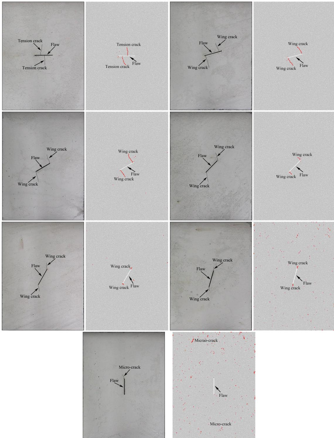
Fig. 9. Crack initiation mode
